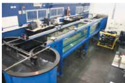
Laboratório de Fluido-dinâmica Experimental e Velocimetria Laser, Canal de Água Circulante, NDF.
