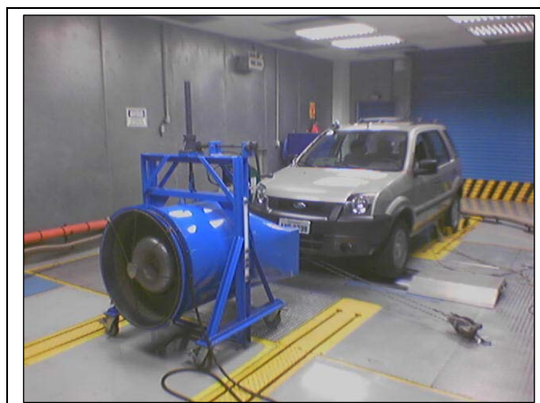
Figura 4.1 Veículo instrumentado em uma câmara climatizada com dinamômetro
